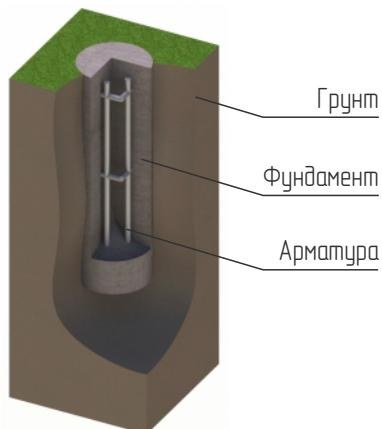
В качестве фундамента под столб с фланцем может применяться любой вид фундамента (ленточный, монолитный и т. д.).
