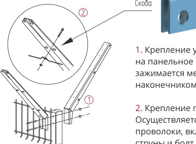
1. Крепление универсального наконечника на панельное ограждение. Панель зажимается между универсальным наконечником и столбом.
