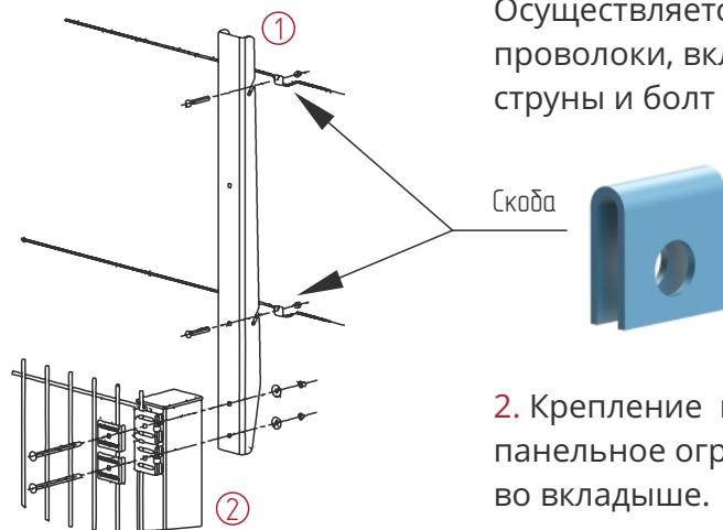
1. Крепление проволоки к наконечнику. Осуществляется при помощи фиксатора проволоки, включающего скобу для струны и болт M6x40 с гайкой M6
